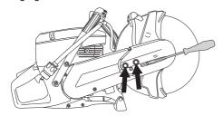
Retirer ensuite les écrous et démonter la protection de la courroie.
