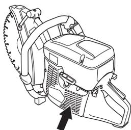
**AVISO** Una toma de aire sucia u obturada produce el sobrecalentamiento de la máquina, con las consiguientes averías del cilindro y el pistón.
