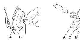
ブレードを固定するねじの締め付けトルク:15~25 Nm (130~ 215 in.lb)<sub>o</sub>
