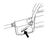
スイッチロックを押して、解除したときにスイッチが元の位置に戻ることを確認します。
