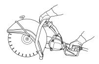
• 右手の親指でスイッチロックを押し、スイッチを押します。
