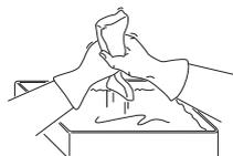
将滤清器放在塑胶袋中并倒上滤清器油。揉捏塑胶袋使油散开。挤出塑胶袋内滤清器多余的油，倒出多余的油，然后将滤清器安装到机器上。千万不要使用常用的机油。这样会很快渗透滤清器并且聚集在底部。
