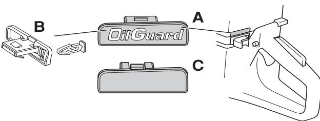
如果您想重新启动 OilGuard 系统，可再次按下 OilGuard 插塞。系统会被重新启动，但要注意：断掉的指示器针不能重新安装。指示器针断掉，显示OilGuard 系统曾经被切断。您可以购买一个新的指示器针作为备件，但是仅有灰色出售，以表示自本机出厂后 OilGuard 防油器系统曾被停用过。
