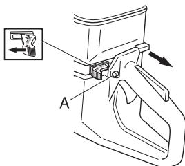
自动减压阀 机器配有自动减压阀, 这样会比较容易启动切割机。
