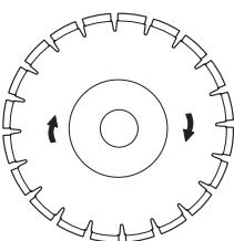
使用金刚石锯片时，确保按照锯片上箭头指示同一方向旋转。
