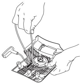
取掉启动器绳索的杂物，并检查复位弹簧是否正常运作。通过启动器箱体和绳索滑轮中的孔插入新启动器绳索。
