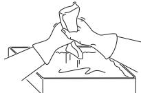
把滤清器放入塑胶袋并倒入滤清器油。揉捏塑料袋以分配油量。把塑胶袋中滤清器剩余的燃油挤干, 装上滤清器之前倒空剩余的燃油。小心! 千万不可使用一般的发动机油。
