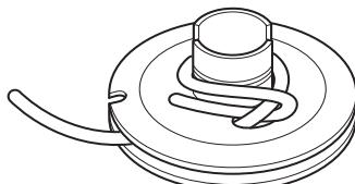
将绳索穿过滑轮边缘的开口，并在滑轮中心上顺时针绕大约 3 圈。
