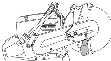
当金刚石锯片被安装在动力切割机上时，确保按照锯片上箭头指示同一方向旋转。
