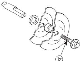
不要使用弯曲、有凹口、不整齐或肮脏的凸缘垫片。不要使用尺寸不对的凸缘垫片。
