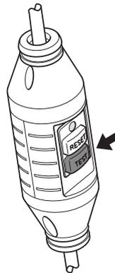
漏电保护器应启动，机器也立即关闭。如果情况与此不同，请与您的经销商联系。
