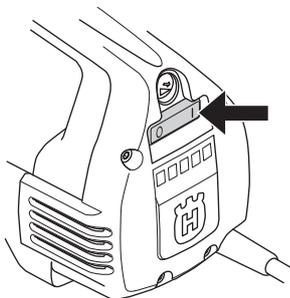
Фиксаторът за включване трябва да се използва за стартиране и спиране на машината.
