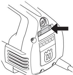
Hlavný vypínač sa používa na spustenie a zastavenie stroja.
