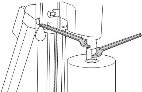
Předtím než stroj spustíte, pečlivě zkontrolujte, zda je nový vrták pevně upevněn.
