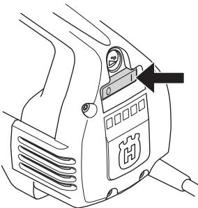
Vypínač proudu se používá ke spuštění a zastavení stroje
