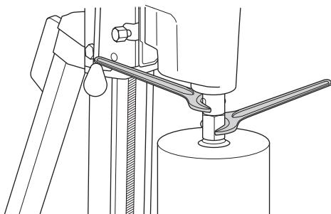
Pred zapnutím stroja dôkladne skontrolujte, či je nový vrták pevne pripojený.
