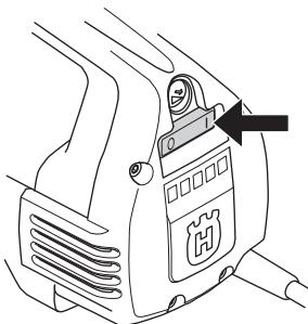
Wyłącznik służy do uruchamiania i wyłączania maszyny.
