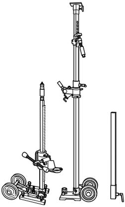
ハスクバーナ DS 50 ジャイロは、コンクリートドリリングマシンあるいはコアコレクターを取り付けるための伸縮式リグシステムです。システムは、さまざまな設定オプションを装備したモジュール方式を採用しており、壁、フロア、天井への真直ぐな穿孔あるいは角度を付けた穿孔が可能になります。
