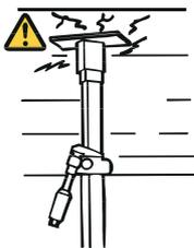
インナーイヤーにフォークが固定されていることを確認します。適切なスパナーで締めてください。
