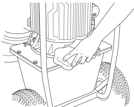
OBS! Unngå å rengjøre strømagggregatet med høytrykksspyler. Maskinen må ikke vaskes med vann. Det kan føre til at vann kommer inn i det elektriske systemet eller motoren, og forårsaker skade eller kortslutning.
