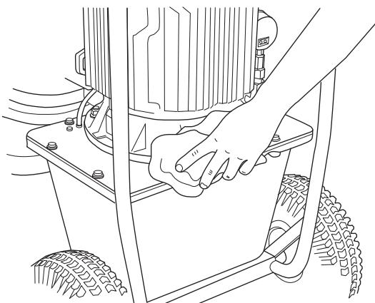
BEMÆRK! Brug ikke en højtryksrenser til at rengøre kraftenheden. Vask ikke maskinen med vand, da vand kan trænge ind i det elektriske system eller motoren og forårsage skade på maskinen eller kortslutning.
