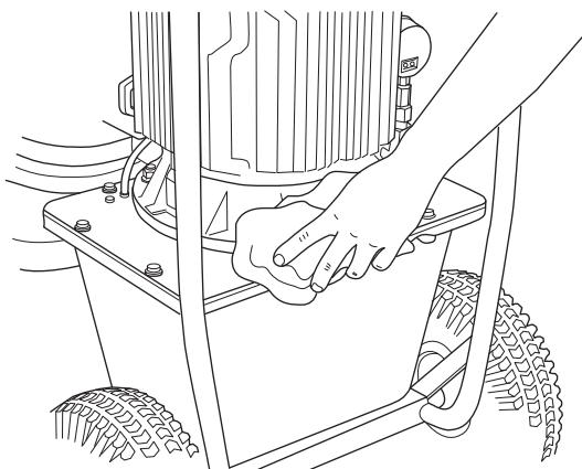
**OBS!** Använd inte högtrycksvätt för rengöring av kraftaggregatet. Spola inte maskinen med vatten, eftersom vatten kan tränga in i elsystemet eller motorn, vilket kan orsaka maskinskador eller kortslutning.
