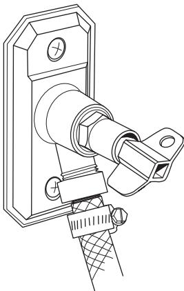
Selv om værktøjet ikke kræver vand, bør der alligevel strømme kølevand igennem køleren og derefter til nærmeste gulvafløb.
