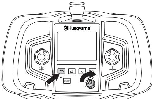
Si la válvula de agua está ajustada en «AUTOM.», existe un retardo de 3 segundos antes de que comience la rotación del disco. El retraso sirve para enfriar la unidad de alimentación, que puede calentarse cuando está activa y no hay agua refrigerada en circulación.
