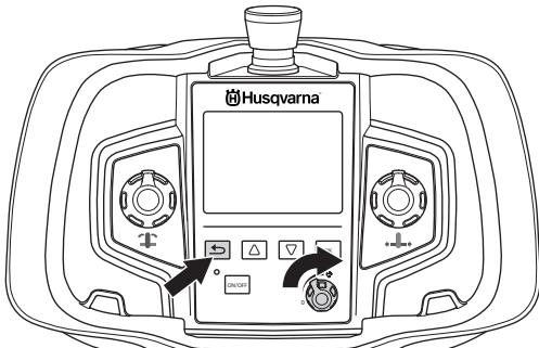
Befindet sich das Wasserventil in der Einstellung „AUTO“, startet die Trennscheibendrehung mit einer Verzögerung von 3 Sekunden. Die Verzögerung dient zur Abkühlung des Aggregats, da es heiß werden kann, wenn es in Betrieb ist und kein Kühlwasser zirkuliert.
