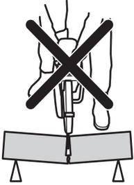
Wird die Klinge eingeklemmt oder bleibt sie im Rückschlagbereich stecken, kann die Heftigkeit der Rückschlageffekte zu heftigen Drehbewegungen und starkem Wackeln des Trennschleifers führen, was schwere oder tödliche Verletzungen verursachen kann.
