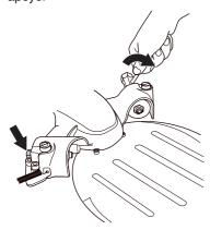
Desenrosque los tornillos de ajuste unas vueltas.
