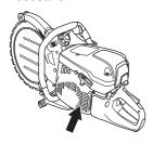
AVISO Una toma de aire sucia u obturada produce el sobrecalentamiento de la máquina, con las consiguientes averías del cilindro y el pistón.
