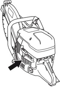
**HINWEIS!** Eine Verschmutzung oder Verstopfung des Lufteinlasses führt zur Überhitzung des Gerätes, die Schäden an Zylinder und Kolben zur Folge haben kann.
