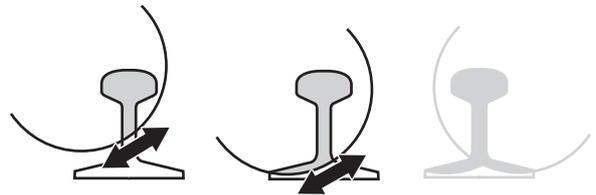
Wenn der Schnitt von einer Seite nicht beendet werden kann, muss der Trennschleifer umgedreht werden.
