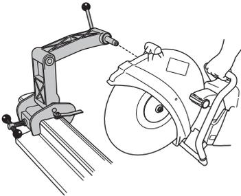
**HINWEIS!** Die Schienenvorrichtung muss an die Schiene montiert werden, bevor der Trennschleifer an der Schienenvorrichtung angebracht werden kann. Mit dieser Vorgehensweise soll sichergestellt werden, dass die Schienenvorrichtung rechtwinklig zur Schiene montiert wird.
