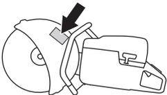
Bei Ersetzen der Buchse muss das Etikett am Gerät durch den entsprechenden Aufkleber ausgetauscht werden.
