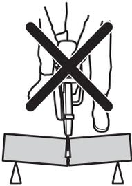
Wird die Klinge eingeklemmt oder bleibt sie im Rückschlagbereich stecken, kann die Heftigkeit der Rückschlageffekte zu heftigen Drehbewegungen und starkem Wackeln des Trennschleifers führen, was schwere oder tödliche Verletzungen verursachen kann.
