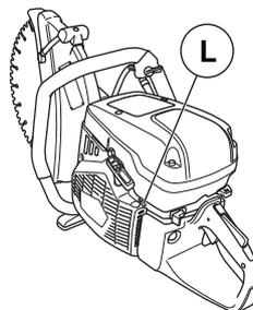
**AVISO** Un ajuste muy pobre del tornillo de baja velocidad (tornillo muy cerrado) ocasiona dificultades en el arranque.
