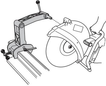
**AVISO** Debe montar en el riel el dispositivo de riel antes de hacer lo mismo con la cortadora en este. Todo ello para garantizar que el dispositivo se monta en el riel en los ángulos adecuados.
