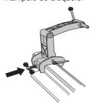
Monte o cortador de disco com o lado direito voltado para a fixação. O suporte no cortador de disco é colocado o mais perto do fuso no disco de corte quando se monta a partir deste lado. A montagem deverá ser assim ser principalmente executada a partir desta direcção.
