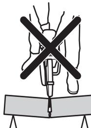
Ak sa kotúč zasekol alebo uviazol v zóne spätného nárazu, reakčná sila rotačným pohybom vyhodí rozbrusovaciu pílu dozadu smerom na používateľa a môže spôsobiť vážne alebo dokonca smrteľné zranenie.
