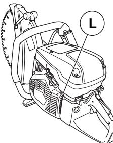
**NAPOMENA!** Isuviše slabo podešena igla donje brzine (L-igla previše zatvorena) dovodi do poteškoća pri paljenju motora.
