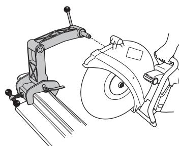
**NAPOMENA!** Potrebno je da se stega za šine prvo postavi na šine pre nego što se motorni sekač postavi na stegu. To je potrebno kako bi se obezbedilo da stega za šine bude pričvršćena uz šine pod pravim uglovima.
