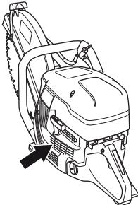
**NAPOMENA!** Prljav ili začepljen dovod vazduha dovodi do pregrevanja mašine, a samim tim do oštećenja klipa i cilindra.
