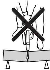
Si l'équipement de coupe se pince ou se coince dans la zone de rebond, la force de réaction va pousser la machine vers le haut, puis la faire retomber en direction de l'utilisateur dans un mouvement de rotation qui peut causer des blessures sérieuses, voire mortelles.
