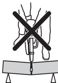
Se l'attrezzatura di taglio è schiacciata o bloccata nel settore di contraccolpo, la forza di reazione respingerà la macchina in senso rotatorio in alto e indietro verso l'utente causando lesioni gravi o mortali.
