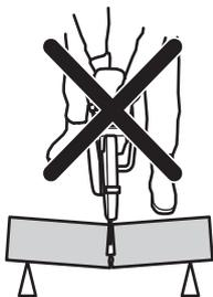
Caso o equipamento de corte fique preso ou entalado no sector de risco de retrocesso, a força reactiva faz com que a máquina seja arremessada para cima e para trás num movimento rotativo, podendo causar ferimentos graves e mesmo mortais.
