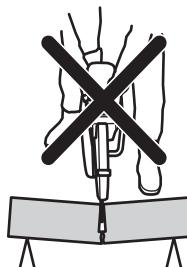
Ak sa rezné zariadenie zaseklo alebo uviazlo v zóne spätného nárazu, reakčná sila rotačným pohybom vymršti stroj dozadu smerom na používateľa a môže spôsobiť vážne alebo dokonca smrteľné zranenie.
