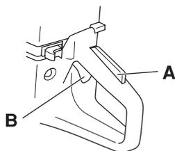
只要油门被按下，扳机锁就会保持按下。松开把手，油门扳机和油门锁将都返回到原来的位置。这是通过两个独立的复位弹簧系统来进行。这意味着油门自动地锁定在闲置位置。
