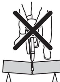
如果锯片在反拨区被夹住或者受阻，反作用力会将动力切割机上下抛动、旋转着直奔用户，造成严重甚至致命性伤害。
