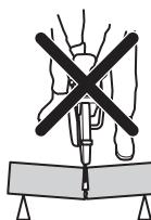
Wird die Klinge eingeklemmt oder bleibt sie im Rückschlagbereich stecken, kann die Heftigkeit der Rückschlageffekts zu heftigen Drehbewegungen und starkem Wackeln des Trennschleifers führen, was schwere oder tödliche Verletzungen verursachen kann
