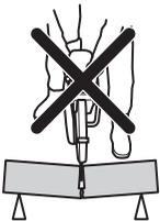
Jeżeli tarcza zaciśnie się lub zaklinuje w strefie odbicia, siła reakcji pchnie przecinarękę do góry i do tyłu w stronę użytkownika w ruchu obrotowym, powodując poważne lub nawet śmiertelne obrażenia.
