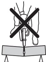
Ha a korong a visszarúgási zónában csípődik be vagy akad el, a gép a reakcióerő hatására forgó mozgással felfelé és hátra dobódik, a felhasználó felé, és így súlyos, akár halálos sérülést is okozhat.
