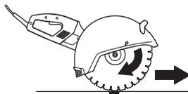
A korong becsípődése vagy elakadása esetén azonban a reakcióerő megnő, és a kezelő elvesztheti uralmát a gép fölött.
