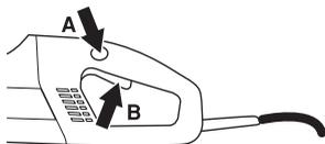
Zarážka vypínače zůstane stisknuta tak dlouho jak je stisknut vypínač. Povolíte-li úchvat držadla přejde jak vypínač tak i zarážka vypínače zpět do původní polohy. K tomu dojde pomocí dvou na sobě nezávislých systémů zpětných per. Tato poloha má za následek to, že se stroj zastaví a vypínač se zablokuje.
