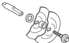
Nepoužívejte nikdy křivé, uražené, naražené nebo znečištěné podložky příruby. Nepoužívejte podložky příruby různých rozměrů.
