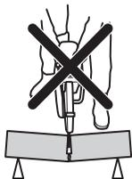
Ak sa kotúč zasekol alebo uviazol v zóne spätňého nárazu, reakčná sila rotačným pohybom vyhodí rozbrusovaciu pilu dozadu smerom na používateľa a môže spôsobiť vážne alebo dokonca smrteľné zranenie.
