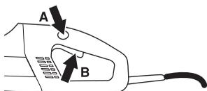
Blokada wyłącznika pozostaje wciśnięta dopóki, dopóki wciśnięty jest wyłącznik. Po zdjęciu ręki z uchwytu zarówno wyłącznik jak i blokada wyłącznika powracają do położenia wyjściowego. Ruch ten kontrolują dwie niezależne od siebie sprężyny powrotne. Oznacza to, że z chwilą puszczenia uchwytu maszyna zatrzymuje się i wyłącznik zostaje zablokowany.
