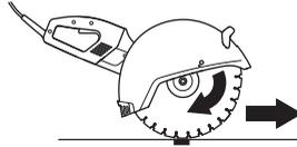
Pokud dojde k zaseknutí kotouče, tato reaktivní síla se znásobí a může dojít ke ztrátě kontroly nad rozbrušovací pilou.
