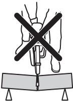
Jeżeli tarcza zaciśnie się lub zaklinuje w strefie odbicia, siła reakcji pchnie przecinarękę do góry i do tyłu w stronę użytkownika w ruchu obrotowym, powodując poważne lub nawet śmiertelne obrażenia.
