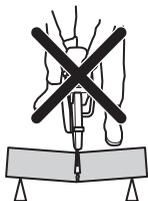
Ak sa kotúč zasekol alebo uviazol v zóne spätného nárazu, reakčná sila rotačným pohybom vyhodí rozbrusovaciu pílu dozadu smerom na používateľa a môže spôsobiť vážne alebo dokonca smrteľné zranenie.
