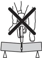
Ha a korong a visszarúgási zónában csipődik be vagy akad el, a gép a reakcióerő hatására forgó mozgással felfelé és hátra dobódik, a felhasználó felé, és így súlyos, akár halálos sérülést is okozhat.
