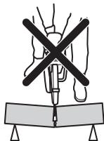
Pokud dojde k zaseknutí kotouče v zóně zpětného rázu, reaktivní síla rozbrušovací pilu vymrští směrem nahoru a zpět k uživateli rotačním pohybem způsobujícím vážné nebo dokonce smrtelné zranění.
