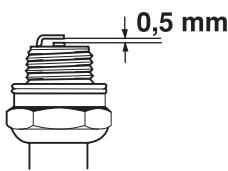
**NAPOMENA!** Uvek upotrebjavaj preporučen tip svećice! Pogrešna svećica može da dovede do teškog oštećenja klipa/cilindra.
