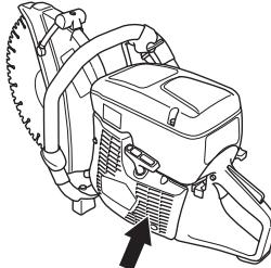
**NAPOMENA!** Prljav ili začepljen dovod vazduha dovodi do pregrevanja mašine, a samim tim do oštećenja klipa i cilindra.
