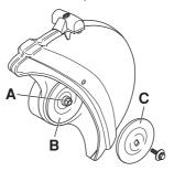
Welle sperren. Führen Sie ein Werkzeug in das Trennaggregat ein und drehen Sie die Klinge, bis diese einrastet.
