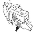
HINWEIS! Eine Verschmutzung oder Verstopfung des Lufteinlasses führt zur Überhitzung des Gerätes, die Schäden an Zylinder und Kolben zur Folge haben kann.
