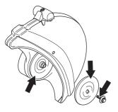
Keine schiefen, beschädigten oder schmutzigen Flanschscheiben verwenden. Keine Flanschscheiben mit unterschiedlichen Durchmessern verwenden.
