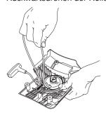
Eventuelle Reste des alten Startseils entfernen und prüfen, dass die Startfeder funktioniert. Das neue Startseil durch die Öffnung im Startvorrichtungsgehäuse und in der Seilrolle führen.
