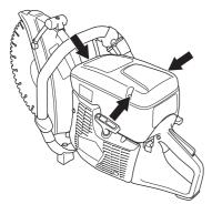
· Luftfilter kontrollieren und bei Bedarf austauschen.
