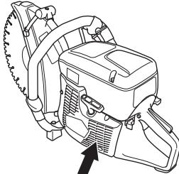
**ΣΗΜΗΙΩΣΗ!** Μία βρώμικη ή φραγμένη εισαγωγή αέρα οδηγεί σε υπερθέρμανση του μηχανήματος, κάτι που προκαλεί βλάβες στο έμβολο και τον κύλινδρο.
