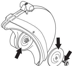
Μεν χρεσιμοποιείτε στραβές, χτυπεμένες ή Βρώμικες ψλάντζες. Μεν χρεσιμοποιείτε ψλάντζες διαψφορετικών διαστάσεων.
