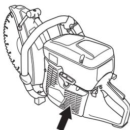
**ATENÇÃO!** Uma entrada de ar obstruída ou suja conduz a um sobreaquecimento da máquina, danificando o cilindro e o pistão.
