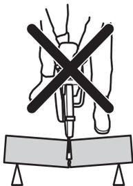
Caso a lâmina fique presa ou entalada na zona de retrocesso, a força reactiva faz com que a máquina seja arremessada para cima e para trás num movimento rotativo, podendo causar ferimentos graves e mesmo mortais.
