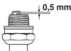
**ATENÇÃO!** Use sempre o tipo de vela de ignição recomendado! Uma vela de ignição incorrecta pode danificar o pistão/cilindro.
