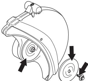
Не пользуйтесь фланцевыми шайбами с перекосом, со сбитыми краями, со следами ударов или грязными. Не пользуйтесь фланцевыми шайбами разных размеров.
