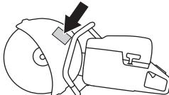
При замене втулки следует обновить маркировку машины с помощью бирки, входящей в комплект поставки.
