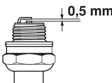
**ЗАМЕЧАНИЕ!** Всегда используйте только указанный тип свечи! Применение несоответствующей модели может привести к серьезным повреждениям поршня/цилиндра.
