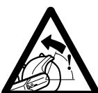
**ПРЕДУПРЕЖДЕНИЕ!** Искры от резчика могут стать причиной воспламенения огнеопасного материала, например: бензина, дерева, сухой травы и т.д.
