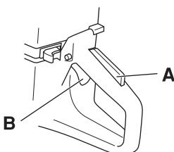
Poistka páčky zostane stlačená, pokiaľ bude stlačený plyn. Keď povolíte stisk držadla, páčka plynu aj poistka páčky plynu sa vrátia do svojej pôvodnej polohy. Je to riadené dvomi nezávislými vratnými pružinovými systémami. To znamená, že páčka plynu sa automaticky zablokuje v polohe voľnobehu.
