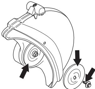
Nepoužívajte prírubové podložky, ktoré sú pokrivené, majú poškodené okraje, vykazujú známky poškodenia nárazom alebo sú znečistené. Nepoužívajte rôzne veľkosti prírubových podložiek.
