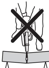
Ak sa kotúč zasekol alebo uviazol v zóne spätného nárazu, reakčná sila rotačným pohybom vyhodí rozbrusovaciú pílu dozadu smerom na používateľa a môže spôsobiť vážne alebo dokonca smrteľné zranenie.
