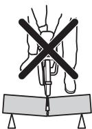
Si la lame se pince ou se coince dans la zone de rebond, la force de réaction va pousser la découpeuse vers le haut, puis la faire retomber en direction de l'utilisateur dans un mouvement de rotation qui peut causer des blessures sérieuses, voire mortelles.
