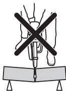
Caso a lâmina fique presa ou entalada na zona de retrocesso, a força reactiva faz com que a máquina seja arremessada para cima e para trás num movimento rotativo, podendo causar ferimentos graves e mesmo mortais.
