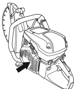
**ATTENTION !** Une prise d'air sale ou bouchée provoque la surchauffe de la machine, ce qui endommage le piston et le cylindre.
