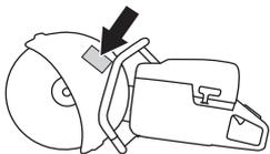
Lorsque vous remplacez la bague, mettez à jour l'étiquetage de la machine à l'aide de l'autocollant fourni.
