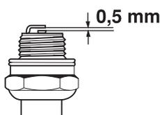
**ATTENTION !** Toujours utiliser le type de bougie recommandé! Une bougie incorrecte peut endommager le piston/le cylindre.
