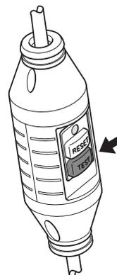
Der FI-Schutzschalter sollte auslösen und das Gerät sofort abgeschaltet werden. Falls dies nicht geschieht, den Händler zurate ziehen.
