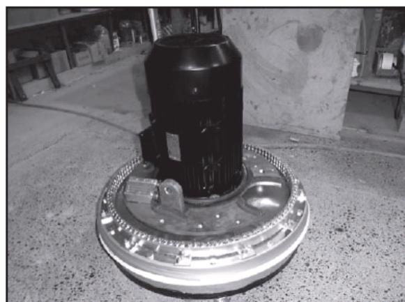
マシンカバーを持ち上げて、チェーンリングとプラネタリーシールが見えるようにしてください。
