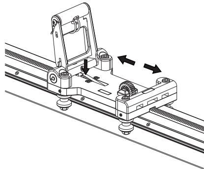
Serrez les vis à l'aide d'une clé à six pans de 8 mm. Répétez l'étape précédente.
