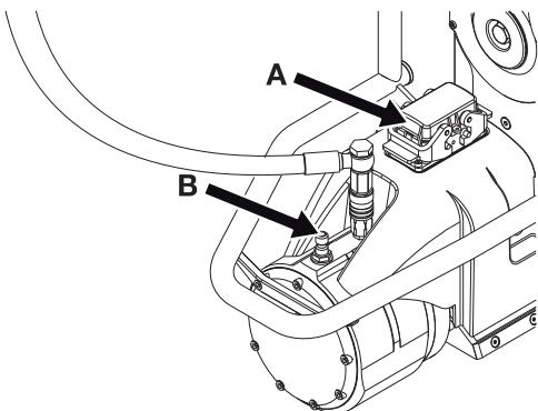
Una vez conectado el cable a la sierra, debe conectarse el mosquetón del cable a la sierra para evitar presión en el enchufe durante el funcionamiento. El mosquetón debe fijarse a uno de los orificios del soporte de la manivela atornillada a la parte posterior del motor de accionamiento.
