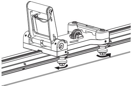
Maintenez la clé mixte de 16 mm en position et serrez les deux vis d'arrêt à l'aide d'une clé à six pans de 3 mm.
