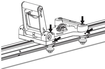
Gire levemente los ejes con una llave de 16 mm hasta que las ruedas guía reposen sobre el riel.
