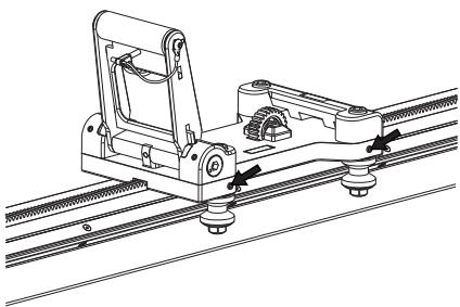
Presione el dispositivo de bloqueo y tire manualmente del soporte de la sierra en ambas direcciones. El soporte debería deslizarse fácilmente, sin apenas oponer resistencia. Deberían girar las cuatro ruedas guía.
