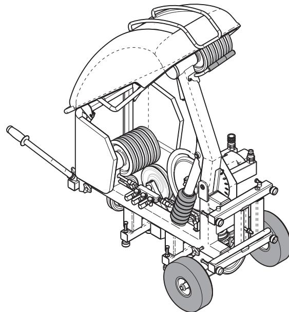
Husqvarna CS 2512 est conçue pour être utilisée avec le groupe hydraulique PP 455 E ou Husqvarna RC 455. Husqvarna CS 2512 est une scie à câble puissante et facile à utiliser présentant une très grande capacité tout en étant suffisamment compacte et mobile pour convenir aux travaux de petite envergure. Elle peut être utilisée de nombreuses manières, sur le sol ou montée sur un mur.
