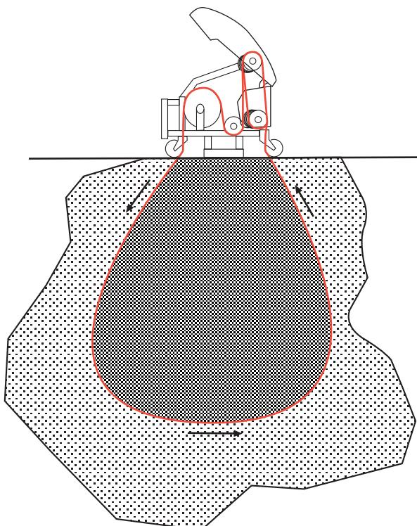
En caso necesario, taladre agujeros para insertar el cable a través del material que se va a cortar.
