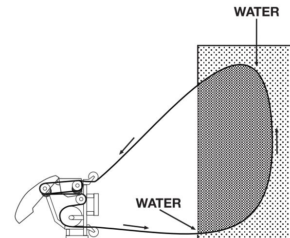
Además del agua refrigerante de la lanza de agua, el cable es lavado junto a las dos ruedas articuladas de la máquina. Así se mantiene el cable lo más limpio posible, con lo que la sierra puede trabajar con menos pérdidas por fricción y mayor rendimiento debido a que el cable está más limpio.
