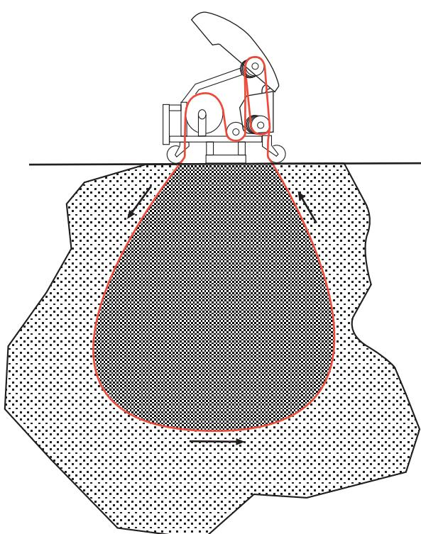
Si nécessaire, percez des trous pour faire passer le câble à travers le matériau à scier.
