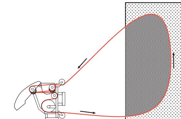
La sierra se monta yacente para hacer cortes a la altura del suelo y para cortes en el suelo.
