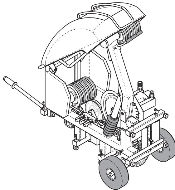
Husqvarna CS 2512 está diseñada para utilizar junto con el equipo hidráulico PP 455 E o Husqvarna RC 455. Husqvarna CS 2512 es una sierra de cable potente y de fácil manejo con capacidad para trabajos verdaderamente grandes, pero es lo suficientemente compacta y móvil para hacer trabajos pequeños. La sierra puede utilizarse de muchas formas diferentes, en el suelo y montada en pared.
