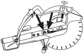
Visser ensuite la vis de réglage jusqu'à ce que l'écrou hexagonal se trouve juste en face du repère sur le capot. La courroie est ainsi tendue automatiquement à la longueur correcte.
