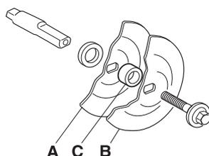
La vis qui maintient le disque de coupe doit être serrée selon un couple de 15-25 Nm.
