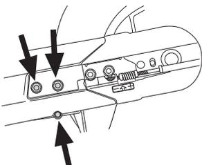
Retirer l'ancienne courroie et mettre en place la courroie neuve. Attacher le bras de coupe à l'unité motrice et tendre la courroie à l'aide de la vis de réglage. Une courroie d'entraînement neuve doit être retendue après environ 30 minutes d'utilisation.
