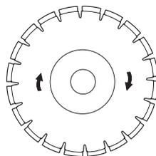
Toujours utiliser une lame diamant acérée. Affûter le disque en coupant un matériau tendre tel que du grès ou de la brique.
