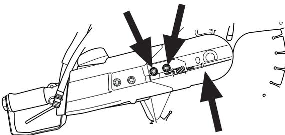
Retirer ensuite les écrous et retirer le capot de courroie avant.
