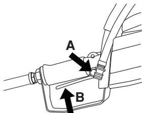
Le blocage d'accélérateur reste enfoncé tant que la gâchette d'accélérateur est sollicitée. Quand la poignée est lâchée, la gâchette d'accélérateur et le blocage d'accélérateur reviennent en position initiale. Ceci s'effectue grâce à deux systèmes à ressorts de rappel indépendants l'un de l'autre. Dans cette position, la machine s'arrête et la gâchette d'accélérateur se verrouille.
