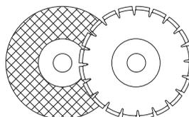
Toujours retirer le disque découpeur pendant le transport. Veiller à utiliser le coussinet correspondant au disque découpeur monté sur la machine. Voir au chapitre Montage du disque découpeur.
