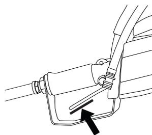
Appuyer sur le blocage d'accélérateur et vérifier qu'il revient en position initiale quand il est relâché.
