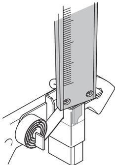
Zamenite ugljenične četke kada rastojanje od držača četke do gornjeg nivoa četke pređe 10 mm.
