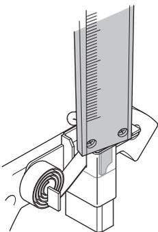
Zamijenite karbonske četkice kada udaljenost od držača četkice do najvišeg nivoa četke premaši 10 mm.
