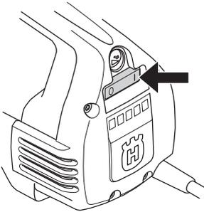
Za pokretanje i zaustavljanje mašine treba koristiti prekidač za uključenje/isključenje.
