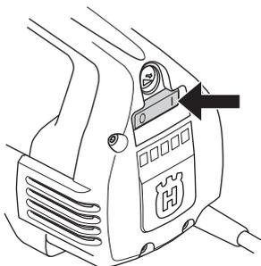
Bušilicu pokrećite i zaustavljajte pritiskom na glavni prekidač.
