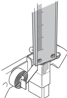
Remplacez les balais de carbone lorsque la distance entre le support de balai et le niveau supérieur du balai dépasse 10 mm.
