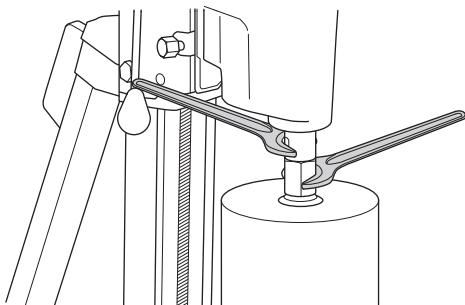
Prima di avviare la macchina, verificare con cura che la punta sia fissata correttamente.
