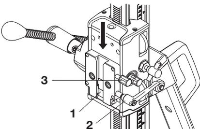
Utilice el tornillo de seguridad superior (3) sólo con DMS 240.
