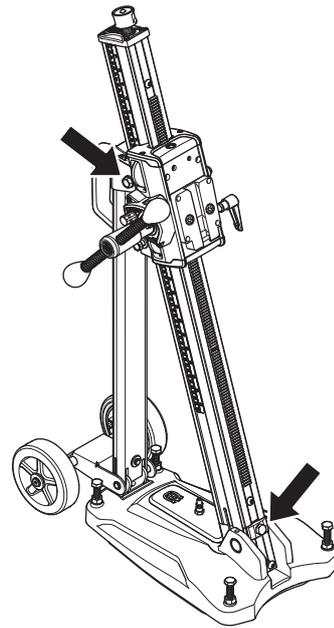
Desserrer les vis de blocage pour l'inclinaison de la colonne et régler l'angle de forage souhaité. Serrer les vis de blocage. Utiliser le levier d'alimentation. La colonne peut être inclinée de 0 à 60°.
