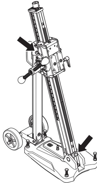
Afloje los tornillos de seguridad de la inclinación de la columna y ajuste como desee el ángulo de inclinación del taladro. Apriete los tornillos de seguridad. Utilice la palanca de alimentación. La columna puede inclinarse 0-60°.
