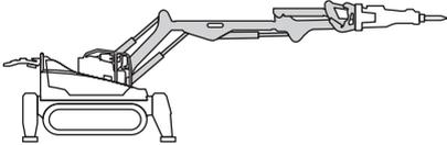
Манипулятор состоит из трех конструктивных элементов, благодаря чему достигается большой радиус рабочей зоны и компактность при необходимости. Выдвижение штоков снижает вероятность появления люфта в шарнирах.
