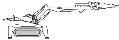
Каждая гусеница приводится во вращение с помощью отдельного гидромотора. Поворот машины осуществляется благодаря разным скоростям вращения гусениц. При вращении гусениц в разные стороны машина разворачивается на месте. Когда приводы гусеницы отключены, приводные двигателя блокируются пассивными тормозами.
