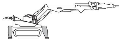
Опоры предназначены для того, чтобы машина была устойчивой. Во время работы машины следует в обязательном порядке выдвигать опоры.
