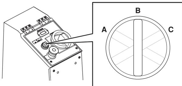
Zur Aktivierung des Fernbedienungsmodus wird der Schalter nach links gedreht (A).
