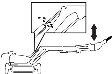
Zylinder 3 wird bis zur äußersten Position gefahren und der Hydraulikhammer ist nach unten gerichtet. Fahren Sie die Zylinder nicht bis zur äußersten Position.
