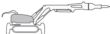
Der Turm lässt sich unbegrenzt drehen, was das Arbeiten in verschiedenen Richtungen ohne Standortwechsel ermöglicht. Die Maschine ist mit einer Schwenkbremse ausgerüstet. Wenn die Drehfunktion nicht aktiviert ist, wird diese durch passive Bremsung gestoppt.
