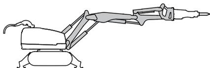
Le système de bras est divisé en trois parties afin de fournir un mouvement large, une portée longue et une compacité. Étirer les arbres minimise le risque de jeu au niveau des joints.
