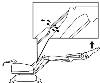
Le cylindre 3 est en position extérieure et le marteau travaille vers le bas. Ne mettez jamais les cylindres en position finale.
