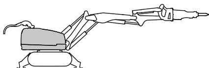
La tour possède une rotation illimitée, ce qui vous permet de travailler dans plusieurs directions sans devoir bouger la machine. La machine est équipée d'un frein d'orientation. Lorsque la fonction de rotation n'est pas activée, elle est freinée par des freins passifs.
