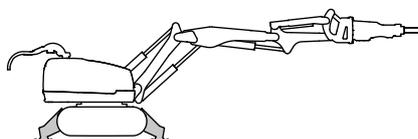
Les lames de bulldozer ont pour fonction principale de donner de la stabilité à la machine. Utilisez-les toujours lorsque vous travaillez avec la machine.
