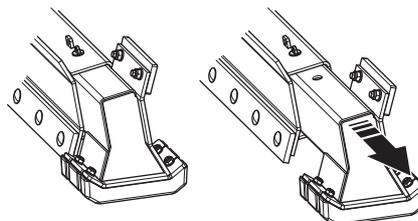
Les pieds des stabilisateurs peuvent être montés orientés vers le haut. De cette façon, le stabilisateur peut être utilisé sans que le pied ne touche le sol.
