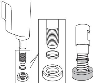
注意！摩擦环可在拆卸钻头时防止损坏心轴和齿轮箱。
