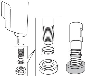
**NOTIS!** Gelang geseran digunakan untuk mengelakkan kerosakan pada aci dan kotak gear semasa membuka bit gerudi.
