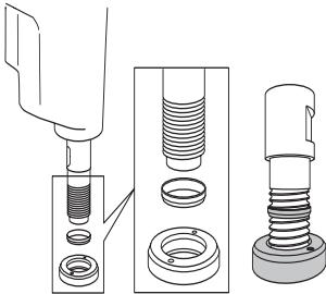
注意!摩擦リングは、ドリルビットを取り外す際にシャフトとギアボックスの破損を防止するために使用します。
