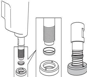
**CHÚ Ý!** Vành ma sát được sử dụng để tránh hư hại cho trục chính và hộp bánh răng trong khi tháo mũi khoan.
