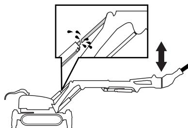
油缸 3 位于远离中心的位置，而锤子工作方向向下。千万不要将油缸置于其终端位置。
