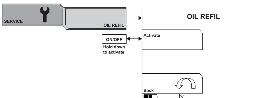
油位通过液压油箱上的观测计读取。如果油位低于最大标记超过一厘米，则要加油。
