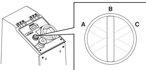
要激活遥控装置模式，请将旋钮旋至左侧(A)。
