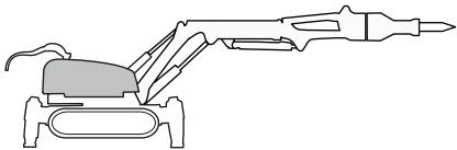
控制台可以任意转动，因此不移动机器就可以在很多方向上工作。机器配备一个旋转制动器。在旋转功能未启用的情况下，该功能会通过被动制动的方式进行制动。
