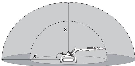
作业区受机器所能到达的位置的限制，而危险区则取决于作业方式、作业对象、表面等。开始作业之前要了解可能存在的危险。如果作业过程中状况发生改变，必须重新确定危险区。
