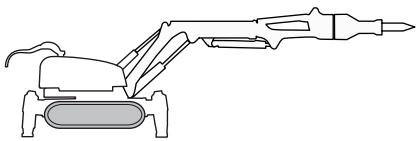
履带分别由液压电机驱动。机器可通过以不同速度运行履带转向。机器可通过在不同方向上运行履带进行安全操作。驱动功能未激活的情况下，被动刹车会锁定驱动电机。
