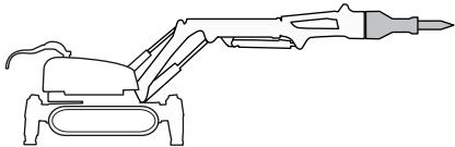
机器应装配适合任务执行的工具。工具的重量和性能要求十分重要，用以确定其是否适合与本机配合使用。详情请参阅“工具”和“技术参数”各章以及工具供应商的说明书。
