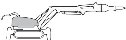
La tour possède une rotation illimitée, ce qui vous permet de travailler dans plusieurs directions sans devoir bouger la machine. La machine est équipée d'un frein d'orientation. Lorsque la fonction de rotation n'est pas activée, elle est freinée par des freins passifs.
