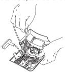
Retirer les restes de l'ancienne corde du lanceur et contrôler que le ressort de démarrage fonctionne.
